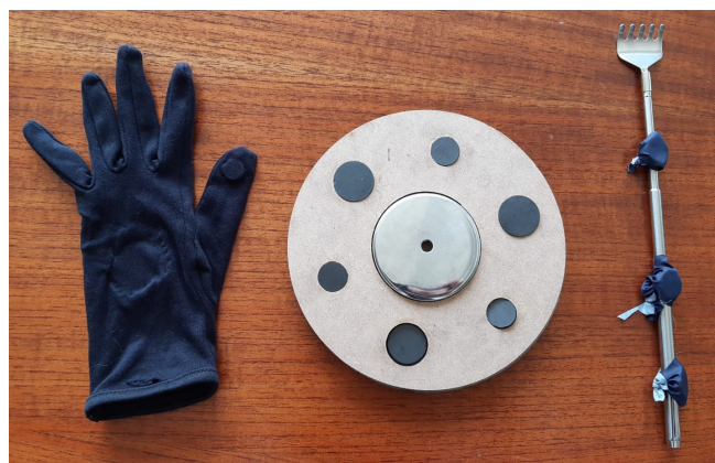
Figura 4. Módulo secundario de mano. Guante con imanes, Base, objeto modificado con imanes.
